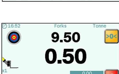
1. Heben Sie in die Wiegeposition. Es ertönt ein Signal und das aktuelle Gewicht wird angezeigt. Halten Sie die Maschine während der Messung ruhig.
